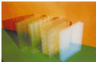
Fig. 3. Algunos tipos de aislación térmica transparente: (de izquierda a derecha), placa de policarbonato simple con celdas verticales, placa de policarbonato doble, placa con celdas de acrílico, placa de aerogel.
