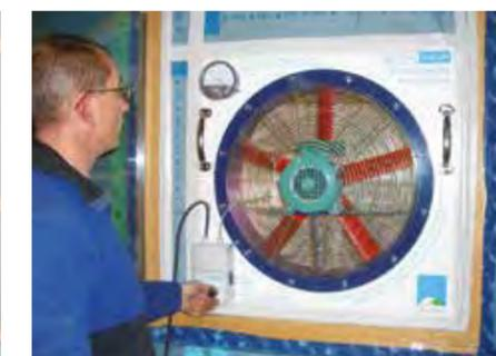
Sind alle Anschlüsse luftdicht hergestellt, ist die Wärmedämmkonstruktion dauerhaft sicher. Empfehlenswert ist die Überprüfung der Luftdichtheit mit einer BLOWER DOOR oder einem pro clima WINCON.
